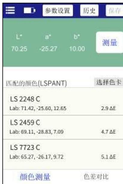
**匹配的颜色：**根据用户所选用的色卡库，匹配出最接近的三种色卡编号进行显示。
