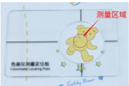
定位孔中心对准测量区域
