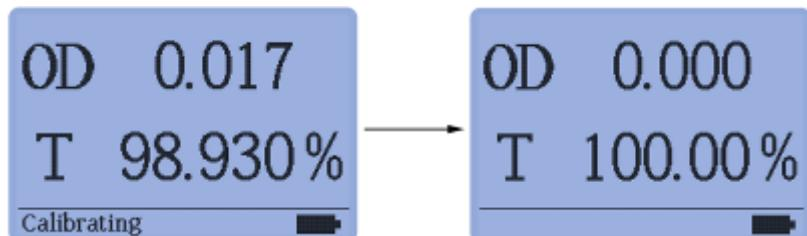
手动校准到 100% 时，如果界面左下角出现“Calibration failed”提示，说明校准失败，手动校准失败可能有以下两个原因引起：
