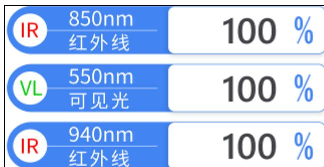
选择“550nm/850nm”，测量界面显示：550nm 可见光透过率、850nm 红外线透过率；
