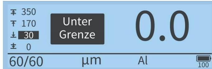
3.5 Nach Abschluss der Nulleinstellung legen Sie den Standardfilm auf die Platte (das Substrat) auf. Wenn der Messwert stabil ist und die Abweichung vom Standardwert innerhalb von  $\pm 5 \mu\text{m}$  liegt, kann das Messgerät ordnungsgemäß verwendet werden.
