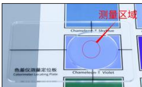
定位孔中心对准测量区域
