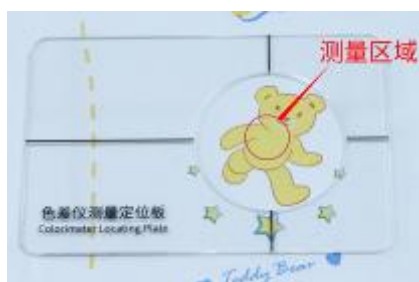
定位孔中心对准测量区域
