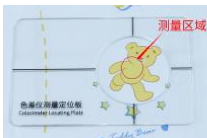
定位孔中心对准测量区域
