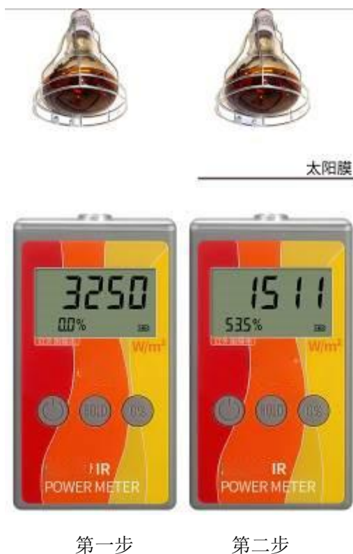
图 1 对太阳膜隔热性能的测量
