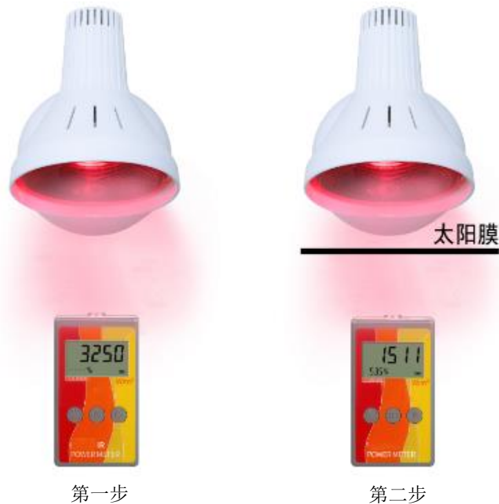
图 1 对太阳膜隔热性能的测量
